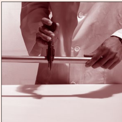
Obr. 21 Řezání trubky Rezanie potrubia
