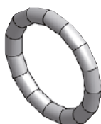
Obr. 3 O-kroužek L.B.P. netěsný před zalisováním O-krúžok L.B.P. netesný pred zalisovaním
